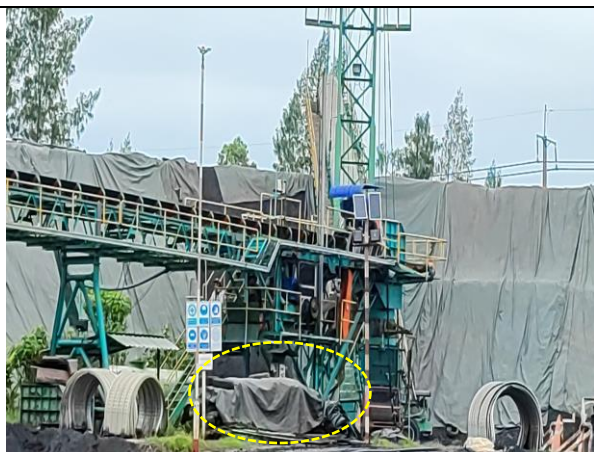
การจัดเตรียมผ้าใบสำหรับปิดคลุมกองถ่านหิน
