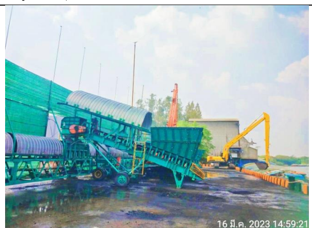
กรณีขนถ่ายถ่านหินลงสู่ระบบสายพานลำเลียง
