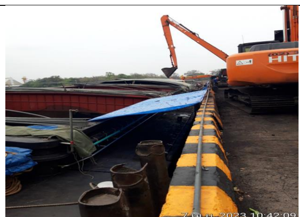
รูปที่ 2.2-11 การชิงผ้าพลาสติกระหว่างท่ากับเรือตลอดแนวระวางสินค้าที่มีการขนถ่ายถ่านหิน
